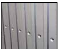
Προκαθορισμένη εισαγωγή δευτερογενούς αέρα καύσης
