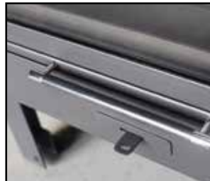
Ρυθμιζόμενη εισαγωγή πρωτεύοντος αέρα καύσης
